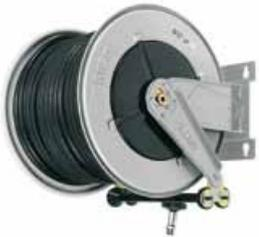
6380-560L Automatik-Hochdruck-Schlauchrolle lackiert 560 für: 60m Ø8/ 60m Ø10+12 Eingang 3/8"IG Ausgang 1/2"IG max. 200 bar
