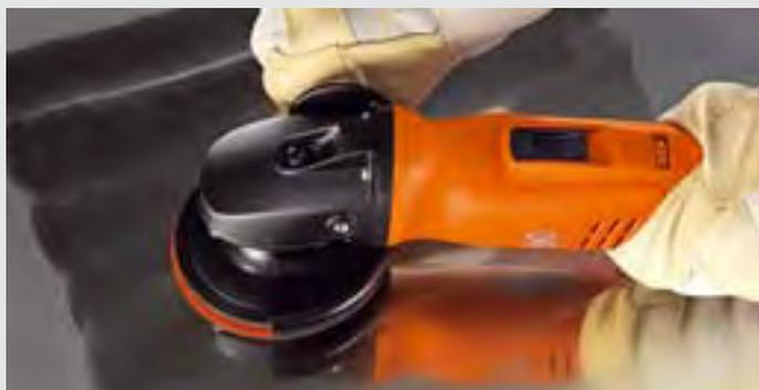
Zubehör für schnelles Entfernen von Kratzern mit hoher Abtragsleistung und geringer Wärmebildung sowie zur optimalen Poliervorbereitung. Mit der neuen Perforation der Pyramix Klettschleifscheibe lässt sich diese zudem auch nach der ersten Randabnutzung weiterverwenden.
