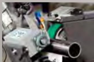
Perfekt für industrielles Rundschleifen in Serie – und schnell im Einsatz. Das GRIT Rundschleifmodul wird einfach und werkzeuglos an der Basismaschine angebracht.
