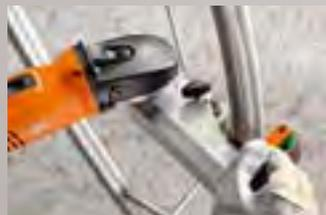
Der Kompakte für den Geländerbau. Der FEIN Rohrschleifer ist aufgrund seiner geringen Größe handlich, auch wenn es eng wird. Die Bandführung bleibt auch bei gebogenen Rohren präzise.
